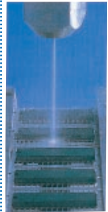
高圧水によるICリードフレームの樹脂バリ取り作業
