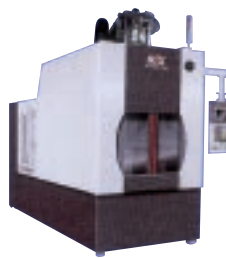
高圧水によるICリードフレームの樹脂バリ取り作業
